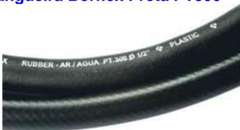
Mangueiras para uso industrial, fabricadas em três camadas, sendo duas delas com uma blenda polimérica com borracha nitrílica e, entre elas, uma como reforço com malha de fios de poliéster industrial de alta tenacidade. Esta composição usada na sua fabricação proporciona excelente flexibilidade e resistência a abrasão e ataque de certos produtos químicos, e a malha de trama de poliéster proporciona a resistência à média pressão.
