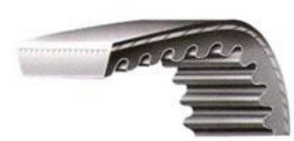
As correias proporcionam sincronismo em ambos os lados e são utilizadas em sistemas com posicionamento variado das polias, permitindo a utilização da mesma correia. O posicionamento dos dentes superiores e inferiores pode ter arranjo simétrico (D) ou arranjo defasado (DZ). Podem ser produzidas em borracha ou PU, e com cordonéis em kevlar, fibra de vidro ou aço.
