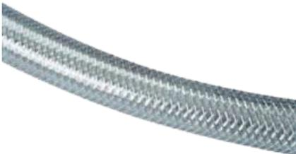
Mangueira flexível fabricada em três camadas, duas de PVC virgem (não reciclado), reforçada com uma malha interna de fios de poliéster industrial de alta tenacidade, resultando em maior resistência e durabilidade quando submetida a médias pressões.
