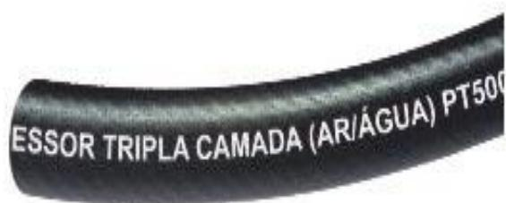
Mangueiras para uso industrial, fabricada em três camadas, duas PVC flexível e, entre elas, uma como reforço de malha de fios de poliéster industrial de alta tenacidade. O composto flexível de PVC utilizado proporciona excelente flexibilidade e a malha de trama de poliéster proporciona resistência à alta pressão.
