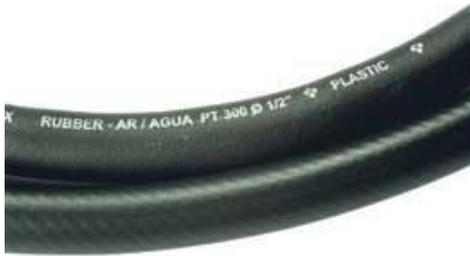
Mangueiras para uso industrial, fabricadas em três camadas, duas em PVC flexível e, entre elas, uma como reforço de malha de fios de poliéster industrial de alta tenacidade. O composto flexível de PVC utilizado proporciona excelente flexibilidade e a malha de trama de poliéster proporciona resistência à média pressão.
