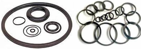
Anéis orings são anéis de vedação redondos, contínuos, com uma seção transversal em forma de círculo. Eles são empregados na sua maioria para vedação estática. Sobre determinadas pré-condições também é possível uma aplicação como elemento de vedação dinâmico, bi-direcional. São os mais versáteis de todos os vedadores e estão presentes na maioria dos sistemas de vedação.
