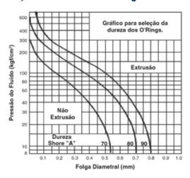
A necessidade do uso de anéis Parbaks® (antiextrusão) dependerá da pressão, do tipo de borracha a ser usado, sua dureza, tamanho da folga diametral e do grau de "dilatação" esperado entre as partes metálicas.
