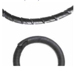
Ao descomprimir-se rapidamente o gás, as "bolhas" se expandem rompendo o composto internamente e explodindo ocasionalmente na superfície do O'Ring.
